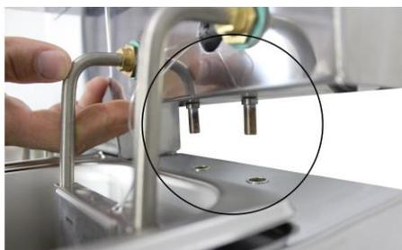
Após montar a cuba, encaixe os dois pinos do painel com a resistência nas furações no gabinete
